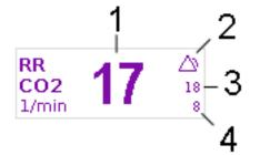
Fig. 6-30 Respiration rate parameter field
